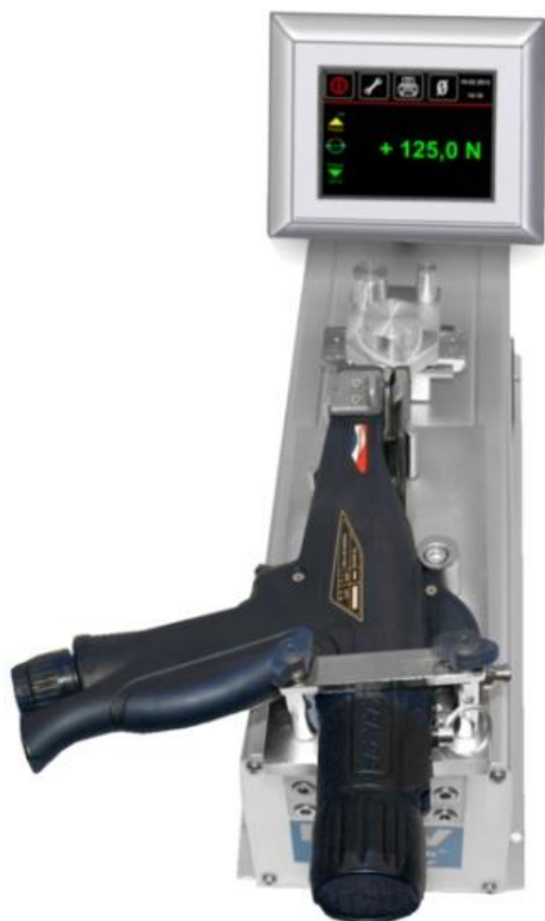
HellermannTyton MK 9 P mit CGT-Touch 50 und KBP
