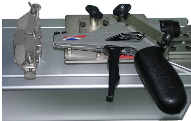
HellermannTyton MK 7 mit CGT 50 und Schnellspanhalter KSH 6
