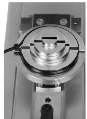
Werkzeugsatz KBS auf C50 Prüfgerät
